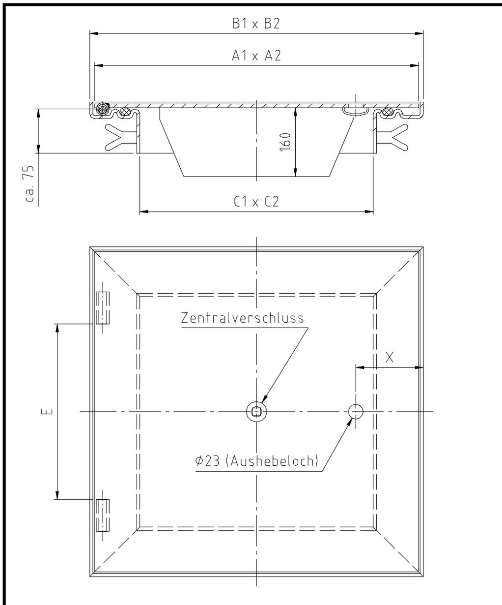
Die Verriegelung erfolgt durch einem Zentralschraubverschluss mit einer Spindel aus Spezialrotguß. Die Schachtabdeckungen sind lackiert oder komplett verzinkt lieferbar.
