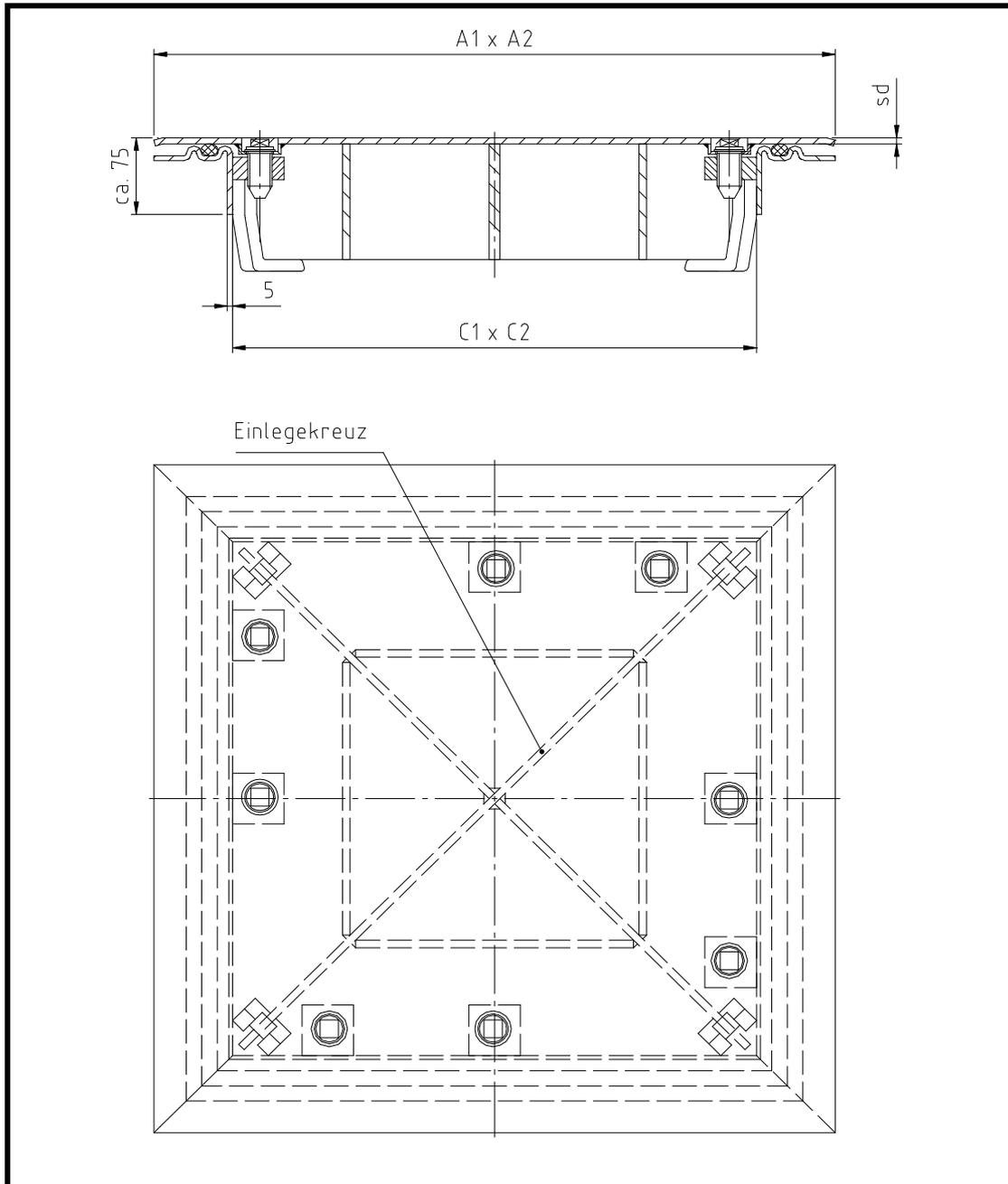
Inkl. Gummidichtung System OTTO und Verschluss mittels Schrauben. Die Schachtabdeckungen sind lackiert oder komplett verzinkt lieferbar.
